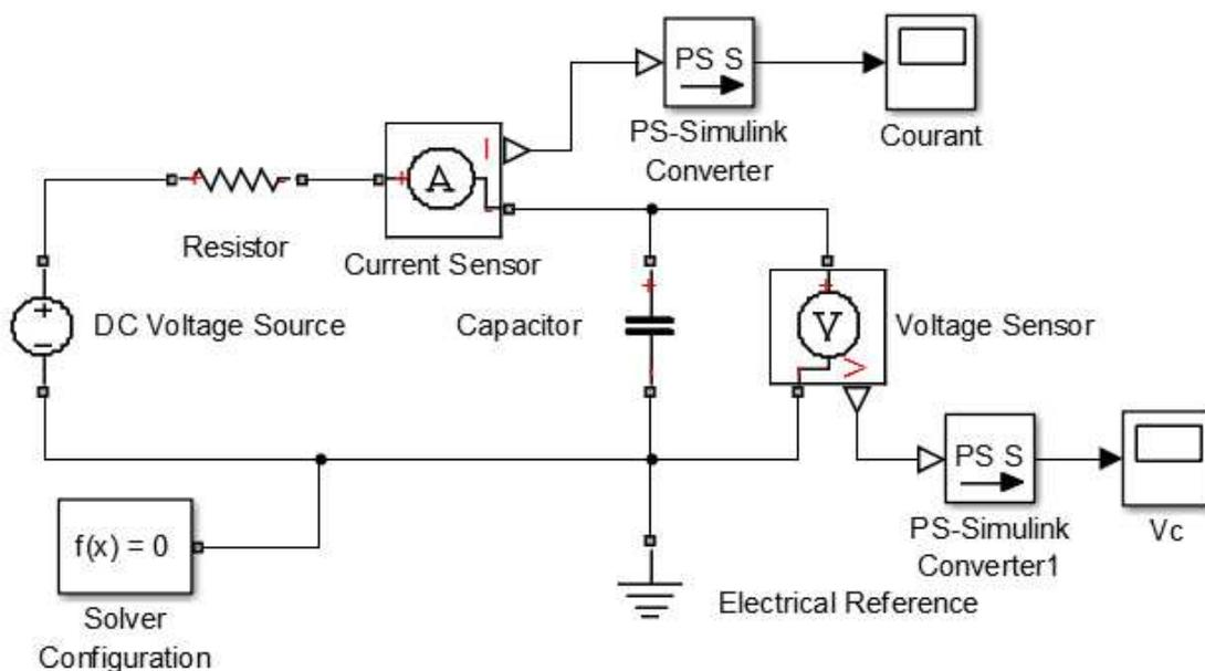
Le même circuit avec Simscape permet un placement de chaque élément tel qu'il le serait dans la réalité (comme le bloc « Current Sensor », un ampèremètre monté en série). Ce schéma permet d'obtenir la tension  $V_c$  et le courant  $I$ . Le bloc « PS-S Simulink Converter » fait la passerelle avec la couche Simulink en convertissant un signal physique d'un diagramme physique acausal en un signal causal vers un bloc Simulink (ici un « Scope » pour tracer la courbe du signal en fonction du temps).
