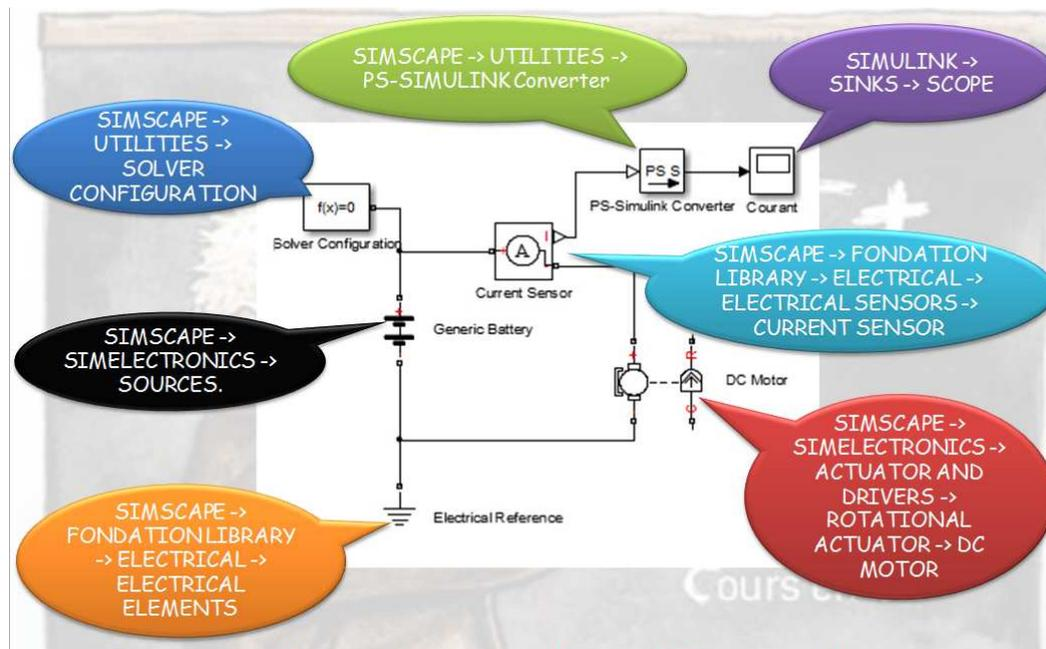
Sur le schéma ci-dessus, la source de tension (« supply rail ») a été remplacée par une batterie. Cette deuxième solution permet la simulation de la décharge de la batterie.
