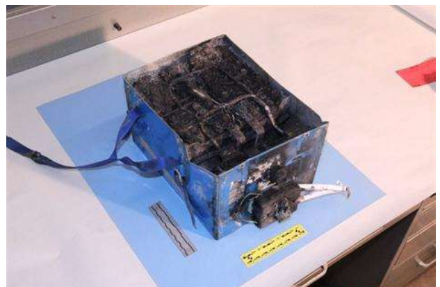
Batterie endommagée du Boeing 787 de Japan Airlines
