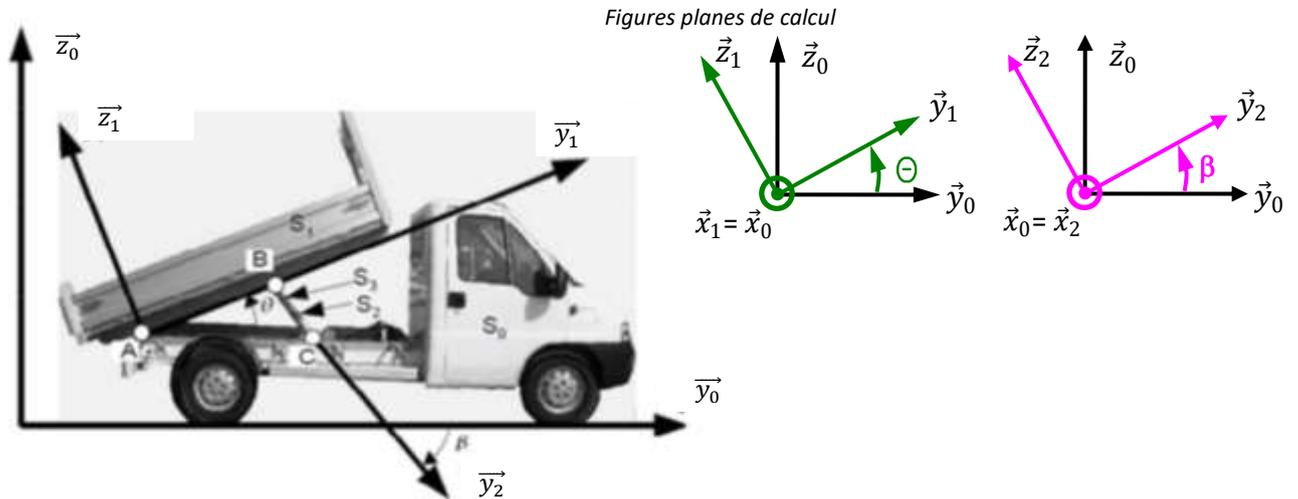
La benne  $S_1$  est en liaison pivot avec le châssis  $S_0$  en A. Le corps de vérin  $S_2$  est en liaison pivot avec le châssis  $S_0$  en C. La tige de vérin  $S_3$  est en liaison pivot avec la benne  $S_1$  en B. Le corps et la tige de vérin sont en liaison glissière d'axe BC.
