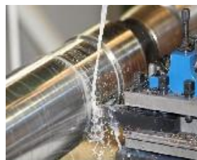
(a) Tournage : rotation de la pièce, translation de l'outil
