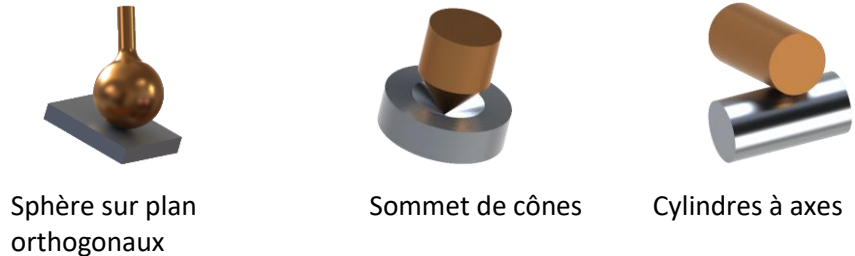
Figure 1 : Exemples de contacts ponctuels
