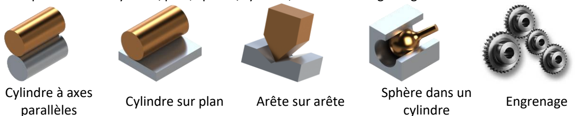
Figure 2 : Exemples de contacts linéiques
