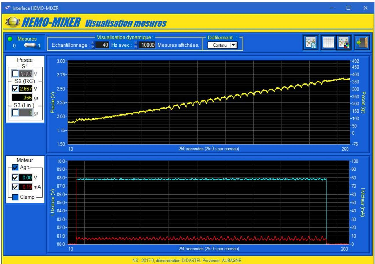
Sur cet exemple, on visualise un cycle complet (pesée du volume prélevé, agitation plateau, etc.) d'un Prélèvement de 280 ml.
