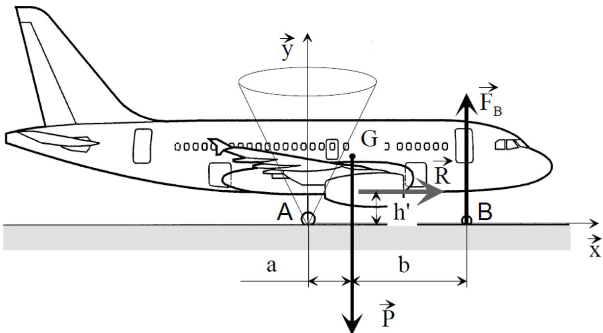
**Figure 22 :** Avion en statique dû au freinage
