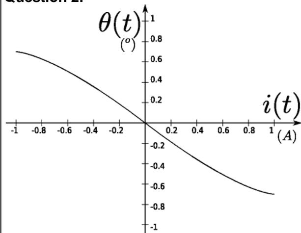
**Figure 19 :** Courbe de réponse du moteur couple
