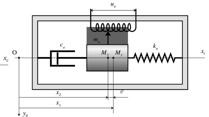
Figure 7 : Accéléromètre soumis à une accélération
