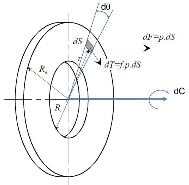
**Figure 12 :** Modèle de contact
