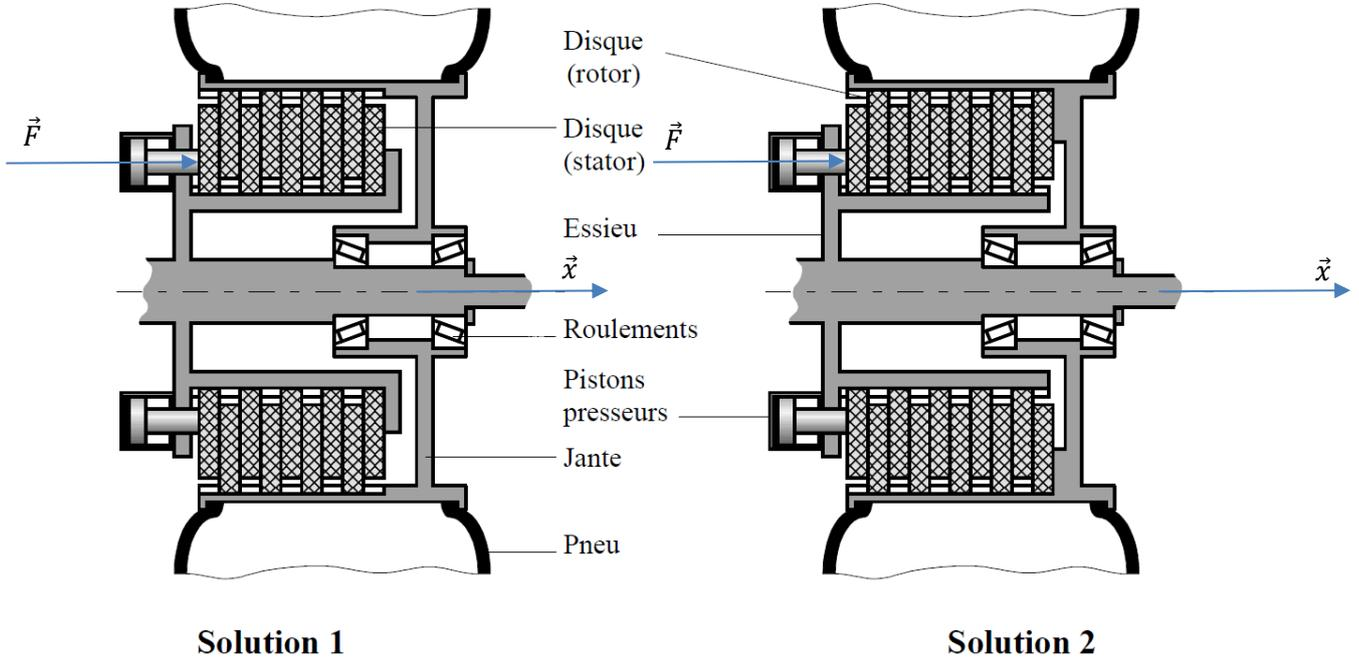
Figure 10 : Montage des disques de freins
