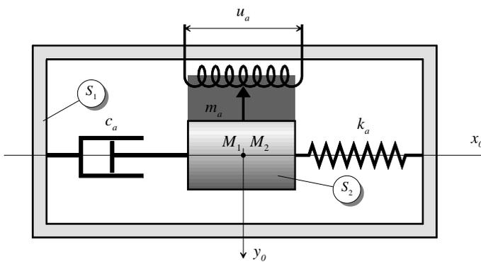
Figure 6 : Accéléromètre en position repos
