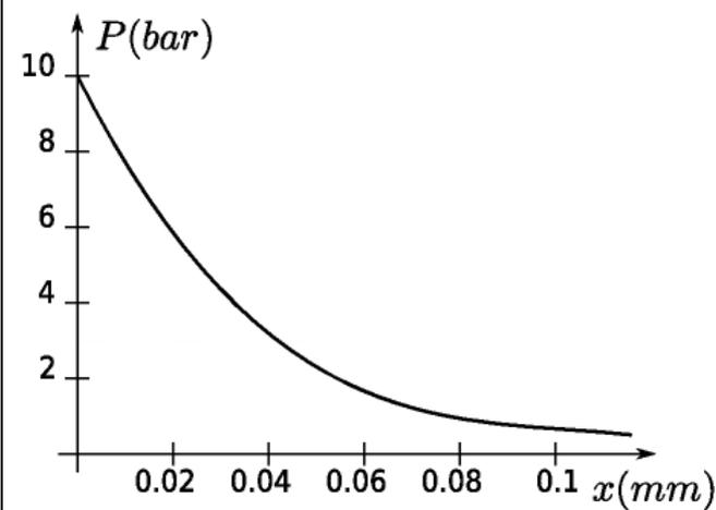
**Figure 20 :** Courbe de réponse d'une buse
