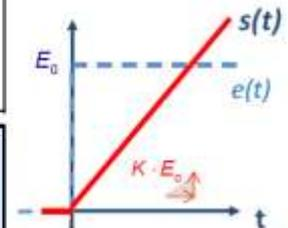
L'identification est réalisée à partir de la **pente  $a$  en régime permanent** avec  $a = K E_0$ .
