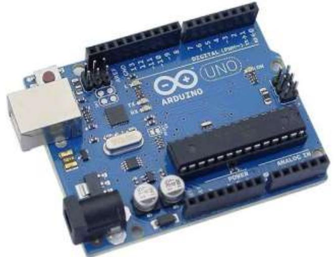
Ces cartes possèdent des broches (pins, ports ou pattes) qui reçoivent les signaux des **entrées** (en provenance des capteurs ou des interfaces homme-machine) **ou** envoient des signaux aux **sorties** (vers les interfaces machine-homme ou préactionneurs). Les mots « entrées » et « sorties » doivent être compris du point de vue du microcontrôleur. On trouve :
