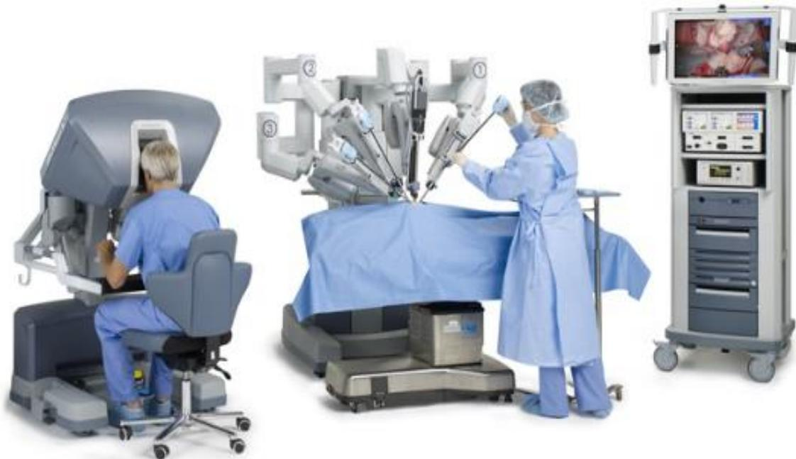
Outre le confort opératoire pour le chirurgien, le principal avantage du système robotisé est de permettre le traitement des ordres générés par la console, avant que ceux-ci ne soient transmis aux robots esclaves.
