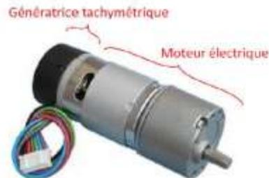
Le moteur est modélisé par la fonction de transfert :  $\frac{\Omega_m(p)}{U_m(p)} = \frac{131}{50+p}$
