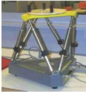
Les plates-formes mobiles, qui font partie des robots dits « parallèles », sont des systèmes constitués d'un plateau mis en mouvement par 6 vérins électriques ou hydrauliques.
