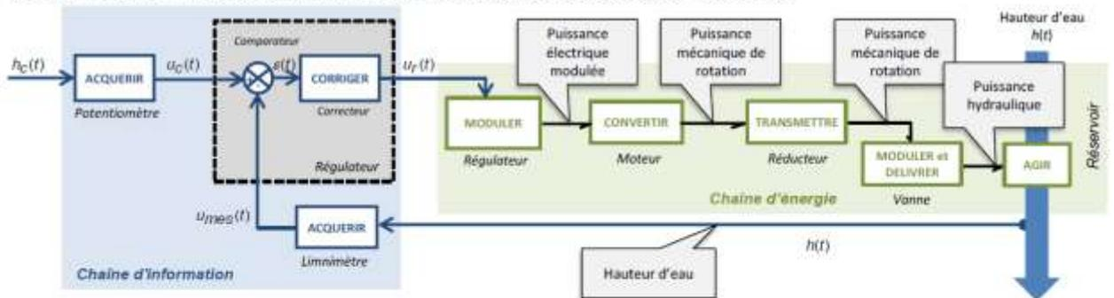
On s'intéresse à la modélisation de la chaîne d'énergie et à une situation dans laquelle le réservoir est fermé en sortie..
