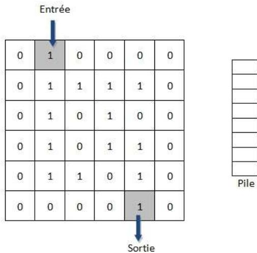
L'idée est de parcourir le labyrinthe depuis l'entrée, en utilisant une pile pour stocker le chemin, pour pouvoir dépiler lorsque le chemin n'aboutit pas et redémarrer sur une autre voie..
