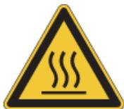
Le dissipateur et toutes les autres parties métalliques peuvent s'échauffer à des températures de plus de 70°C.
