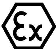
Toutes les entrées de câbles qui ne sont pas utilisées doivent être obturées avec des bouchons borgnes agrés pour les zones à atmosphère explosible.
