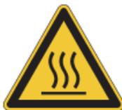
La résistance de freinage et toutes les autres parties métalliques peuvent s'échauffer à des températures de plus de 70°C.
