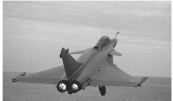
Rafale propulsé par deux moteurs Snecma M88
